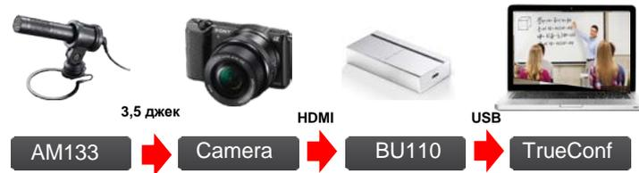
Схема подключения фото/видео камеры и микрофона к ПК с VC платформой
